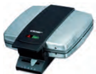
Waffelautomat 1445 24+ für 2 Brüsseler Waffeln je 9 x 15,5 cm (1,7 cm dick), Antihafbeschichtung, stufenlos wählbarer Bräunungsgrad, Backampel, flexibles Scharnier für ein besseres Aufgehen der Waffel, Kabelaufwicklung mit Steckerdepot, platzsparende, auf den Griffen stehende Aufbewahrung
