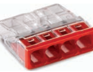
2273-204 VERB.DOSENKL. 4x0,5-2,5 TRANSP. COMPACT-Verbindungsdoosenklemme; für eindrängige Leiter; max. 2,5 mm 2 ; 4 Leiter; Gehäusefarbe transparent; Deckelfarbe rot; Umgebungstemperatur max. 60 °C (T60); 2,50 mm 2 ; transparent
