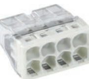
2273-208 VERB.DOSENKL. 8x0,5-2,5 TRANSP. COMPACT-Verbindungsdoosenklemme; für eindrängige Leiter; max. 2,5 mm 2 ; 8 Leiter; Gehäusefarbe transparent; Deckelfarbe lichtgrau; Umgebungstemperatur max. 60 °C (T60); 2,50 mm 2 ; transparent
