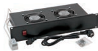
Belüftungseinheit 19 Zoll 2HE 2 Lüfter 19" Belüftungseinheit 2HE, 2xEinschublüfter 220V Thermostat 30W in RAL 7035, Beipack: 4xSchraubenM6x10, 4xKunststoffunterlegscheiben, 4xKäfigmuttern M6
