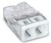
2273-202 VERB.DOSENKL. 2x0,5-2,5 TRANSP. COMPACT-Verbindungsdoosenklemme; für eindrängige Leiter; max. 2,5 mm 2 ; 2 Leiter; Gehäusefarbe transparent; Deckelfarbe weiß; Umgebungstemperatur max. 60 °C (T60); 2,50 mm 2 ; transparent
