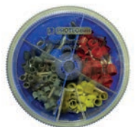
PAEHS2 Streudose Aderendh. 4-16 mm 2 DIN Farbkennung nach DIN 46228, Teil 4, Wärmebeständig bis 105°C, Ausführung: Streudose 4,0 - 16 mm 2 . Bestückt mit: 50 St. 4,0 mm 2 grau, 20 St. 6,0 mm 2 gelb, 20 St. 10,0 mm 2 rot, 10 St. 16,0 mm 2 blau
