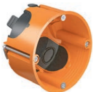
9263-22 Hohlwand Gerätedose O-range ECON Hohlwand Gerätedose, O-range ECON® 63, luftdicht, mit Geräteschrauben, Tiefe 48 mm
