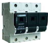
PLTS D02 Lasttrennschalter D02 3-polig Zulassungen: IEC 60947-1:2007 + A1:2010, IEC 60947-3:2008 + A1:2012, VDE 0638/09.81, bedingter Bemessungskurzschlussstrom mit Sicherungseinsätzen 50 kA / 400 V AC / 63 A, für D01- und D02- Sicherungseinsätzen und Hülsen-Passeinsätze nach DIN VDE 0636-3 IEC, Berührungsschutz nach BGV A2,...
