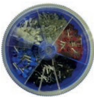
PAEHS2 Streudose Aderendh.0,5-2,5 DIN Farbkennung nach DIN 46228 Teil 4, Wärmebeständig bis 105°C, Ausführung: Streudose 0,5 - 2,5 mm 2 . Bestückt mit: 50 St. 0,5 mm 2 weiss, 100 St. 0,75 mm 2 grau, 100 St. 1,0 mm 2 rot, 100 St. 1,5 mm 2 schwarz, 50 St. 2,5 mm blau
