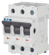
IS-63/3 Hauptschalter Lastschalter mit Trennfunktion, Ausführung entsprechend IEC/EN 60947-3, Hohe Verschleißfestigkeit der Kontakte, Sprungeinschaltung, Knebefarbe schwarz, Klemmquerschnitt 50qmm, Verschienungskompatibel mit Xpole Schutzschaltgeräten bei Verwendung der Maulklemme in Kombination mit Standard...
