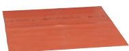
140156 GUMMITUCH 1000MM X 1000MM Abdecktuch, fett- und säurefest, zum Abdecken spannungsführender Teile, VDE 0680/1, 1000V, LxBxH 1000x1000x1, 6mm
