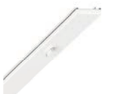
SDBAS 58/1500 Blindabdeckung 1500mm IP54 Design-Zubehör Blindabdeckung Metall, l=1536, für SDT IP40, IP54. Blindabdeckung IP54 aus verzinktem, profiliertem Stahlblech, Oberfläche mit Polyesterharzlack beschichtet, mit zwei Drehverschlüssen für das schnelle Einsetzen in die Tragschiene, zur Überbrückung unbestückter Bandleinheiten,...
