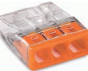
2273-203 VERB.DOSENKL. 3x0,5-2,5 TRANSP. COMPACT-Verbindungsdoosenklemme; für eindrängige Leiter; max. 2,5 mm 2 ; 3 Leiter; Gehäusefarbe transparent; Deckelfarbe orange; Umgebungstemperatur max. 60 °C (T60); 2,50 mm 2
