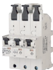
119717 LSHU-E50/3-KL Selektiver Hauptsicherungsautomat zur direkten Montage auf 4- oder 5-polige 40 mm-Sammelschienen-systeme 12 x 5 mm 2 und 12 x 10 mm 2 , Befestigung: Sammelschiene (mit Quick-Adapter)
