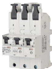
119716 LSHU-E40/3-KL Selektiver Hauptsicherungsautomat zur direkten Montage auf 4- oder 5-polige 40 mm-Sammelschienen-systeme 12 x 5 mm 2 und 12 x 10 mm 2 , Befestigung: Sammelschiene (mit Quick-Adapter)
