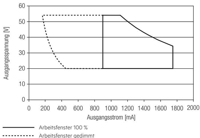
Es ist sicherzustellen, dass der LED-Treiber ausschließlich innerhalb des gezeigten Arbeitsfensters betrieben wird. Besondere Aufmerksamkeit ist dem gedimmten Betrieb sowie dem DC- und Notlichtbetrieb zu widmen, da aufgrund der verwendeten Amplituden-Dimmung die Modulspannung mit dem Dimm-Level variiert. Eine Unterschreitung der spezifizierten minimalen Ausgangsspannung des LED-Treibers kann zur Abschaltung führen.
