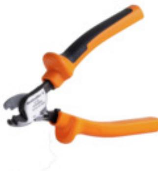
Schneidwerkzeuge für Leiter bis 8 mm, 12 mm, 14 mm bzw. 22 mm Außendurchmesser. Die spezielle Schneidegeometrie ermöglicht ein quetschfreies Schneiden von Kupfer- und Aluminiumleitern mit minimalen Handkräften. Zudem besitzen die Schneidwerkzeuge (KT 8 bis KT 22) VDE- und GS-geprüfte Schutzisolationen bis 1.000 V gemäß EN/IEC 60900.
