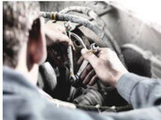
Der Doppelmaul Joker eignet sich hervorragend zum Kontern bei Schraube und Mutter.
