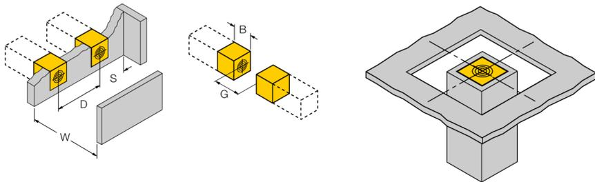
Beim Einbau des Sensors in eine Lochblende (dünne Blechplatte, z.B. Trittblech) muß zur sicheren Erfassung des Targets der Sensor allseitig bündig in Metall eingebaut werden.
