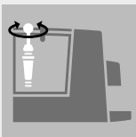
Filter in Wassertank eindreihen
