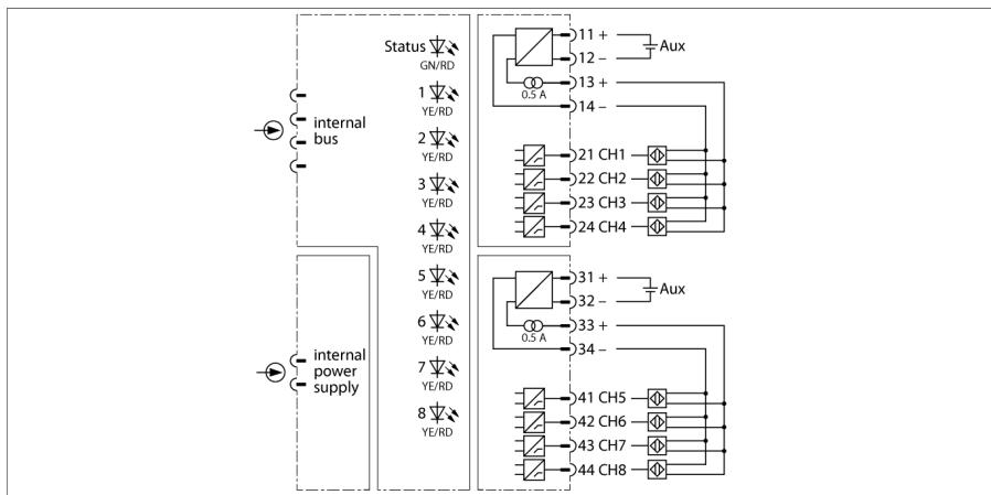
Das digitale Eingangsmodul DI80-N dient zum Anschluss von acht 3-Draht-PNP/NPN-Sensoren (IEC 61131, Type 3). Die Sensorik wird nicht über das Modul gespeist, sondern verpolgeschützt über eine Hilfsenergie, die getrennt für die Kanäle 1...4 (Gruppe 1) und 5...8 (Gruppe 2) extern über die Anschlussklemmen zugeführt wird. Die Eingangsgruppen sind galvanisch von einander getrennt.
