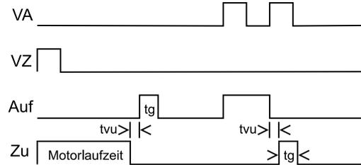
Bei der zusätzlichen Auffächerungs-Funktion (AF) werden nach längerer ZU-Verfahrzeit (>5s) die Lamellen 2s AUF und 2s ZU bewegt. Dadurch werden die Lamellen wieder richtig ausgerichtet.
