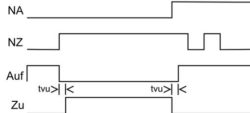
Jalousiemode: Vororteingänge sind bei kurzem Tastendruck pegelgesteuert und bei langem flankengesteuert.
