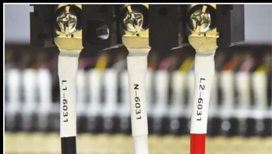
Der nicht-klebende Schlauch ist aus einem speziellen Material hergestellt, der flach zusammengefaltet in der Bandkassette aufgerollt ist. Nach dem Druck wird der Schlauch geöffnet und über ein Kabel oder einen Abschlussstecker gezogen. Bei entsprechender Heizeinwirkung mittels eines Heißluftgerätes, schrumpft das HSe Pro Tape auf die Hälfte seiner ursprünglichen Breite und umschließt das Kabel.
