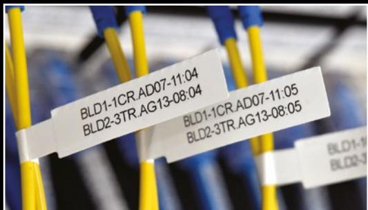
Geeignet für Kabel mit kleinerem Durchmesser, insbesondere zur Identifizierung von Glasfaserkabeln in der Netzwerk-Installation. Das FLe Fähnchen Pro Tape ist speziell vorgefertigt. Nach dem Ausdrucken wird zuerst der längliche Klebestreifen als Fähnchen um das Kabel geklebt, um schließlich daran den bedruckten Bereich längs gefaltet in Position zu bringen.
