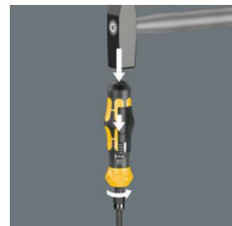
Der Hammerschlagimpuls wird bei zugeschalteter Schlagschrauffunktion in eine Drehbewegung mit einem Lösemoment von bis zu 25 Nm umgesetzt. Die Kraftübertragung erfolgt verlustfrei über eine durchgehende Klinge.
