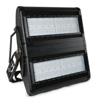
LED-Außenstrahler, Schutzart IP 65, geeignet als Spot- oder Flächenstrahler, vibrationsfest und seewasserbeständig, HD-Kameratauglich, daher geeignet als Sportplatz- und Stadionbeleuchtung, frei von Flickereffekten auch bei Zeitlupen, Gehäusefarbe schwarz, passive Kühlung, Leistungsaufnahme 880 W, verschiedene Optiken, ballwurfsicher nach DIN 18302.
