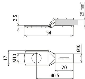
Presskabelschuh nach DIN 46235 mit Nickelsperrschiicht zur Vermeidung von Whiskerbildung.
