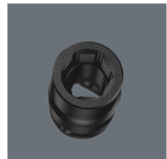
Das Sechskantprofil ermöglicht die Übertragung hoher Kräfte und belastet die Kanten der Schraubenmutter bzw. des Schraubenkopfes weniger als ein Zwölfkantprofil. Feinverzahnte Knarren machen darüber hinaus durch ihren kleinen Rückschwenkwinkel den Einsatz eines Zwölfkantprofils auch in begrenzten Raumverhältnissen überflüssig.
