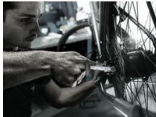
Joker 6003 Gr. 9 für den Anwendungsfall an Schaltwerken (Fahrrad-Gangschaltung)
