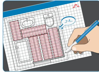
2) Zeichnen Sie einen Positionsplan für Kabel, unbeheizte Enden, den Bodenfühler, das Thermostat und die Anschlussdose (falls vorhanden). Beachten Sie dabei alle derzeitigen und künftigen am Boden montierten Objekte wie Toiletten, Badewannen usw.
