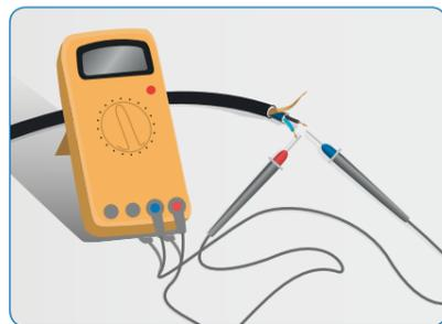
6) Überprüfen Sie den Isolationswiderstand und den Ohmwert der Heizmatten vor, während und nach der Installation. Vergleichen Sie den Ohmwert mit dem auf der Mattenbeschriftung angegebenen Nennwert.
