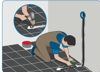
3) Schneiden Sie eine Mauernut aus und befestigen Sie die Kabelführungen und die Anschlussdose. Meißeln Sie eine Nut für den Fühlerkreis und das kalte Kabel heraus. Befestigen Sie den Fühlerschlauch samt Hülse, z. B. mit einer Klebepistole.
