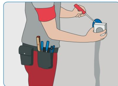
8) Überprüfen und vergleichen Sie den Isolationswiderstand und den Ohmwert der Heizleitungen erneut.
