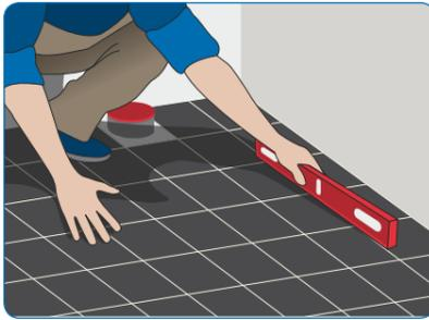
1) Stellen Sie sicher, dass der Unterboden in geeignetem Maße eben, fest und stabil ist.
