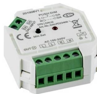
Der DALI-Dimmer-Empfänger kann sowohl über den DALI-Bus, als auch über einen Taster (8V bis 230V/AC/DC) angesteuert werden. Somit können unterschiedliche Verbraucher gedimmt und ein-/ausgeschaltet werden. Die maximale Leistung beträgt 200W für LED-Verbraucher sowie NV-Halogenleuchtmittel und 400W für HV-Halogenleuchtmittel. Protokoll: DT6, DALI2.
