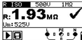
Abbildung 5.7: Beispiel Isolationswiderstandsmessung
