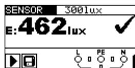
Abbildung 5.47: Beispiel Beleuchtungsstärkemessung
