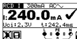
Abbildung 5.20: Beispiel Auslösestrommessung
