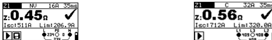
Abbildung 5.29: Beispiel Leitungsimpedanzmessung
