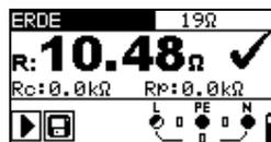
Abbildung 5.35: Beispiel Erdungswiderstandsmessung
