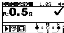
Abbildung 5.12: Beispiel Durchgangsprüfung
