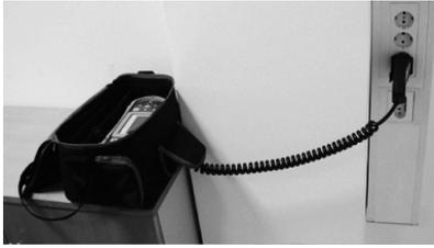
Das Prüfgerät kann auch in der gepolsterten Tasche getragen und liegend verwendet werden. Die Tragetasche besitzt eine Öffnung zur Durchführung der Prüflleitung.
