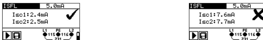
Abbildung 5.44: Beispiele Erstfehler-Leckstrommessung
