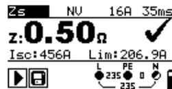
Abbildung 5.25: Beispiel Schleifenimpedanzmessung
