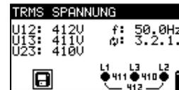
Abbildung 5.4: Beispiele für Spannungsmessungen im Einphasen- und Dreiphasensystem
