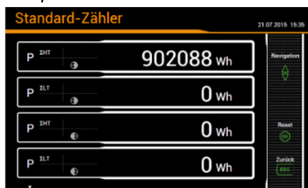
PQ3000: Zähler mit Tarif- und Quadranten- Information
