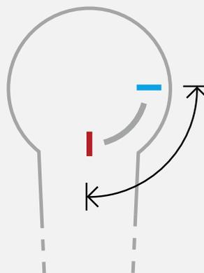
Die optimale Hebelstellung für energieeffizient warmes Wasser ist die Mitte (ideale Nutztemperatur 35 °C, 38 °C oder maximal 45 °C).
