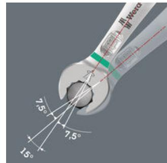
Durch die um 7,5° geschwenkte Maulseiten, die Doppelsechskantgeometrie und eine angepasste Anwendungsweise (Ansetzen - Schrauben - Drehen - erneut Ansetzen - Schrauben - Drehen usw.) können auch Schraubosituationen gelöst werden, die weniger als 30° Schwenkwinkel zulassen.
