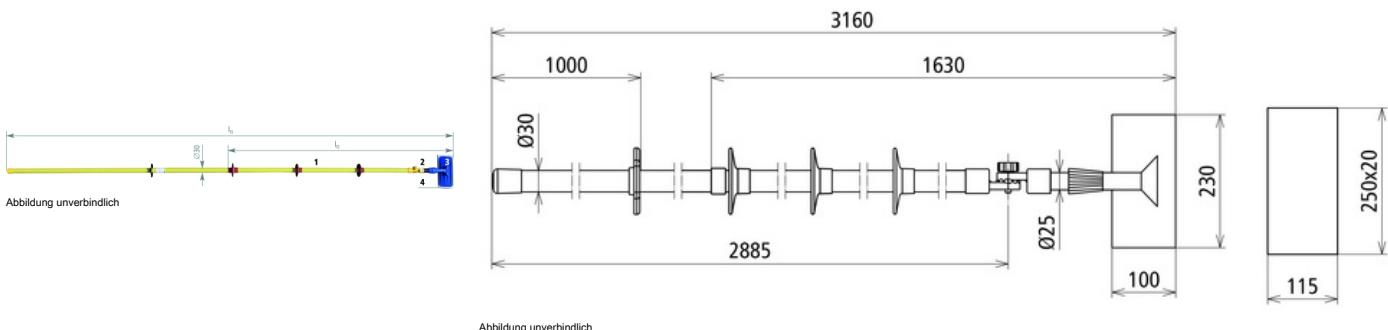
Isolierstangenset zum Reinigen der Sichtscheiben von E-Loks
