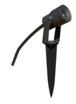
Die Leuchte kann entweder mittels des montierten Bügels direkt auf dem Untergrund, oder optional mit dem mitgeliefertem Erdspieß im weichen Untergrund montiert werden. Am Strahler befindet sich eine 1,5m lange Anschlussleitung mit freien Aderenden. Der Schwenkwinkel der Leuchte beträgt 45°. Der Erdspieß hat eine Länge von 170mm.
