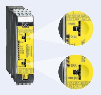
Die Funktionseinstellung erfolgt über den Drehschalter "mode".
