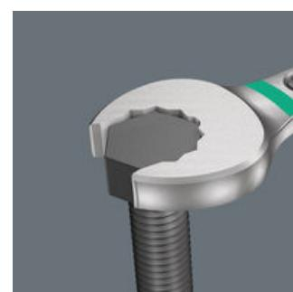
Die Doppelsechskantgeometrie an der Maul- und der Ringseite sichert die formschlüssige Verbindung mit dem Schraubenkopf oder der Mutter und verringt die Abrutschgefahr.
