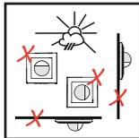
Unsachgerechte Montage bzw. nicht bestimmungsgemäßer Einsatz behindert den einwandfreien Betrieb oder führt zur Zerstörung des Gerätes.
