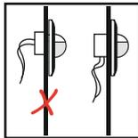
Geeignet für den Einbau in eine 60 mm Unterputzdose. Der Kabeleinlass sollte senkrecht erfolgen.
