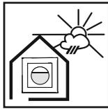
Gerät an einem geschützten Ort montieren bei Wandmontage auf 1,10 bis 2,20 m Höhe.
