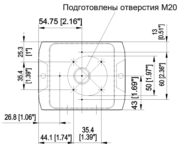
Схема расположения отверстий внутри корпуса (PA 1)
