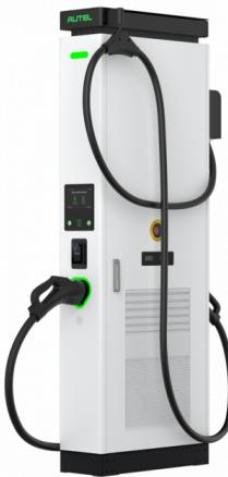
Dieser Dispenser mit einem Megawatt Charging System Ladepunkt und einem CCS2 Ladepunkt bietet unglaubliche Ladeleistungen von bis zu 1.200kW bei 1.500A. Dank des Kabelmanagement-Systems sind die flüssigkeitsgekühlten Ladekabel trotz ihres hohen Gewichts gut zu handhaben. Das hochauflösende 8" Touchscreen-Display zeigt alle Informationen übersichtlich an. Aufgrund der extremen Ladeleistungen ist dieser Dispenser überall dort geeignet, wo höchste Anforderungen an kurze Ladezeiten gelten.
