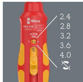
Fünf wählbare Anzugsdrehmomente (2,4; 2,8; 3,2; 3,6; 4,0 Nm) und eine Feststellung (Torque Lock) für unbegrenzte Löse- und Anzugsmomente.
