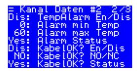
Die Daten in der obigen Abbildung bedeuten Folgendes: Temp-Alarm ist deaktiviert – Dis für Kanal #2 – und die Software regelt die Alarmtemperatur nicht. Der Alarmbereich wird mit Werten von 0 bis 60 °C und der Ist-Temperatur des Sensor außerhalb des Bereichs eingerichtet – der Alarm Status ist Yes.
